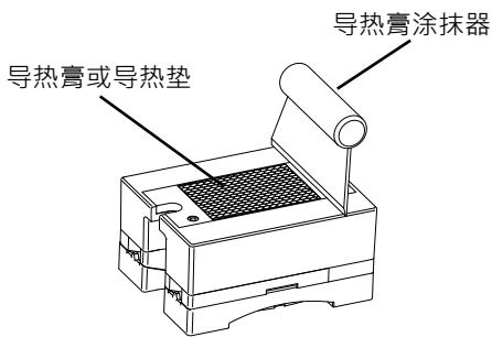
**Fig. 12** 应先在 SSR 的底板上均匀涂抹一层薄薄的导热硅膏，再将其安装到散热器上。也可以使用散热垫来代替。热界面材料会影响热性能。请确保散热器尺寸适当。
