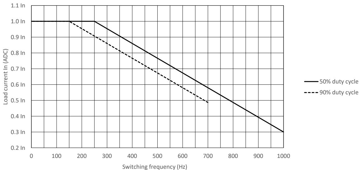
Fig. 6 电流降额vs开关频率<sup>5</sup>
