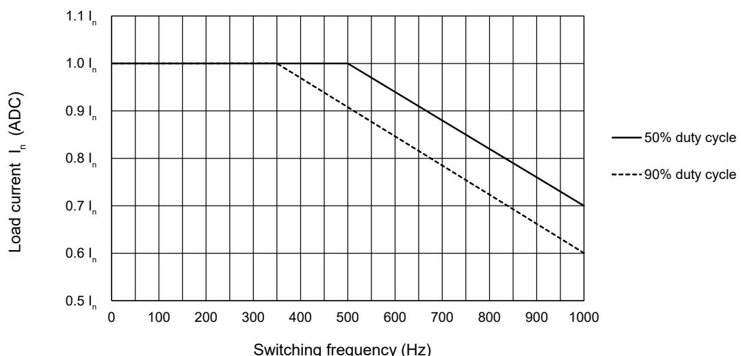
Fig. 4 电流降额vs开关频率
