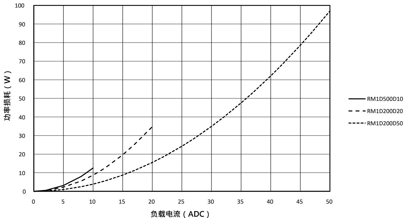
Fig. 9 输出功率损耗图
