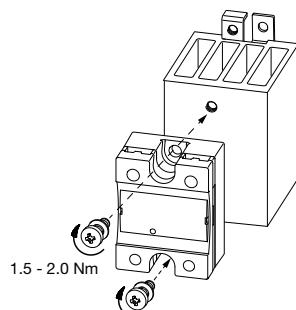
**Fig. 13** 交替拧紧螺丝至最大 0.5 Nm，然后继续拧紧至最大 2.0 Nm。
