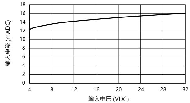
Fig. 3 输入电压与输入电流的关系曲线
