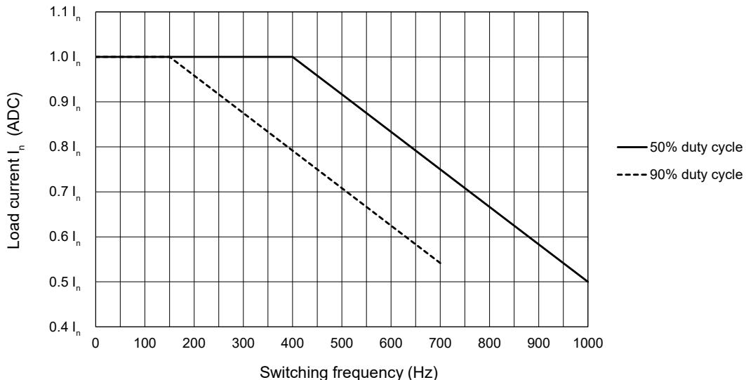
Fig. 5 电流降额vs开关频率<sup>4</sup>
