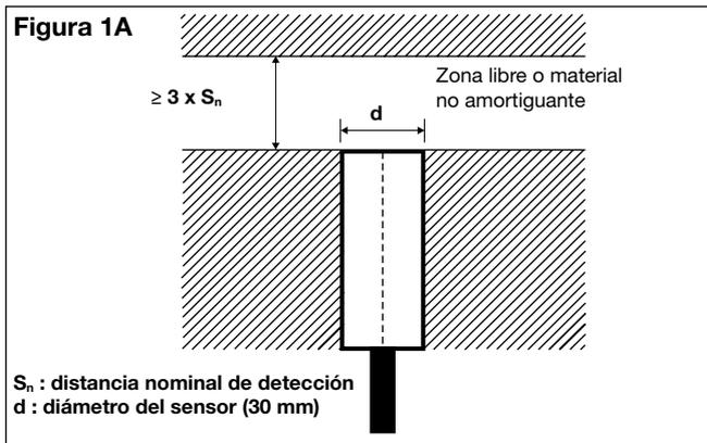
Sensor no empotrado, cuando se instala en material amortiguante debe hacerse según la fig. 1B.
