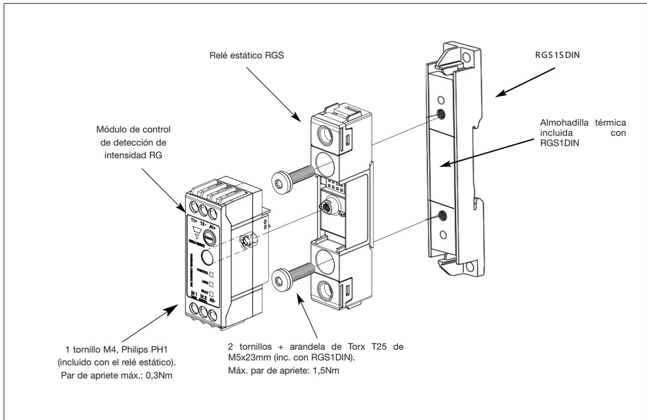
El módulo de potencia del RG se aprieta gradualmente (alternando entre los 2 tornillos) hasta un par de apriete máximo de 1,5Nm. Cuando el módulo de potencia está sujeto al disipador, el módulo de control se puede instalar encima del módulo de potencia y atornillarlo con un par de apriete de 0,3Nm para asegurar un buen contacto entre las 2 unidades.
