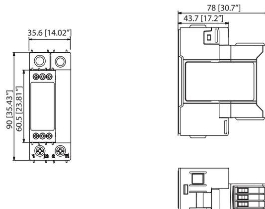
Tolerancia anchura de la caja +0.5mm, -0mm...según norma DIN43880
