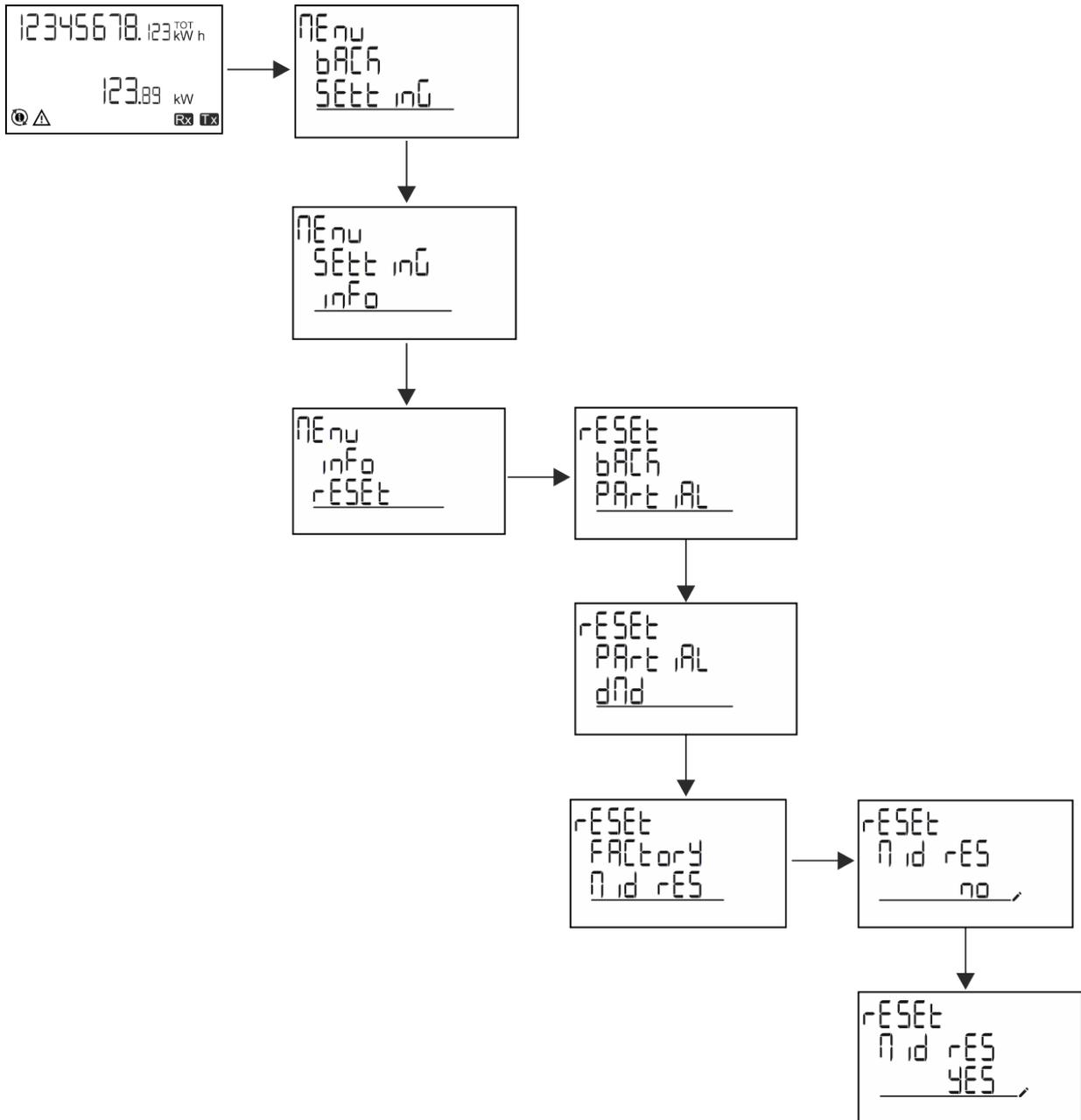
**Info:** Bei MID-Modellen kann der Reset nur durchgeführt werden, wenn der Energiezähler 1 kWh nicht überschritten hat. Im Fall von fehlerhaften Einstellungen können Sie dann eventuelle Einstellfehler des CT Stromwandlers (CT-Verhältnis) korrigieren und damit das MID-Programmierenü wieder aktivieren.
